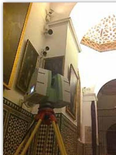
¡El escáner láser en plena captación de puntos
